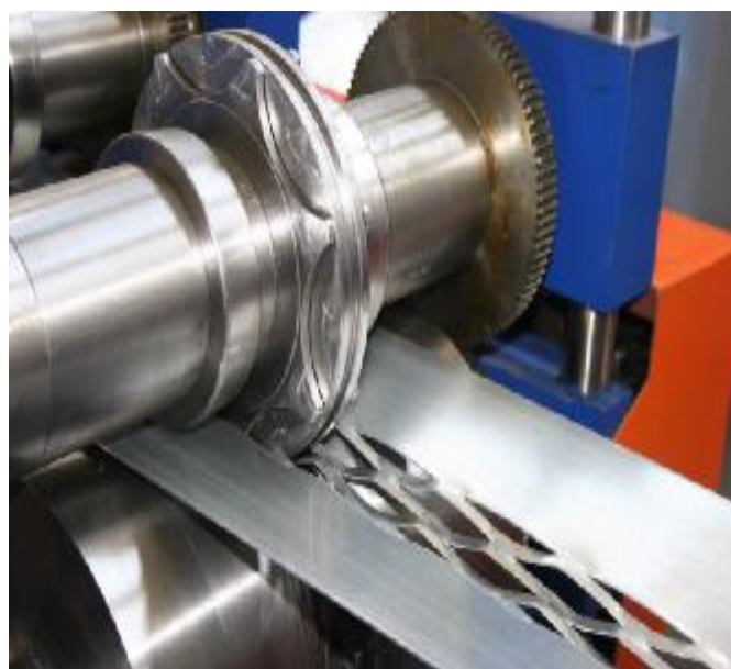
Изготовление сетчатого профиля
